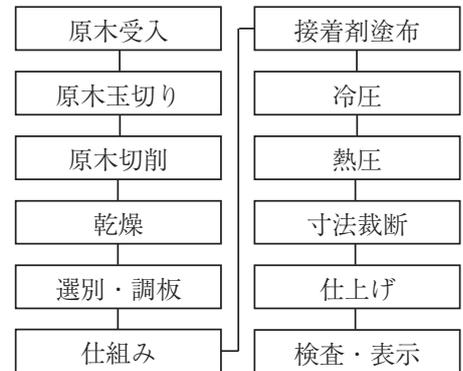
図4-1 合板の製造工程
