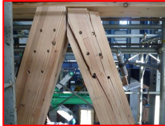
① ブレース端部のせん断破壊
