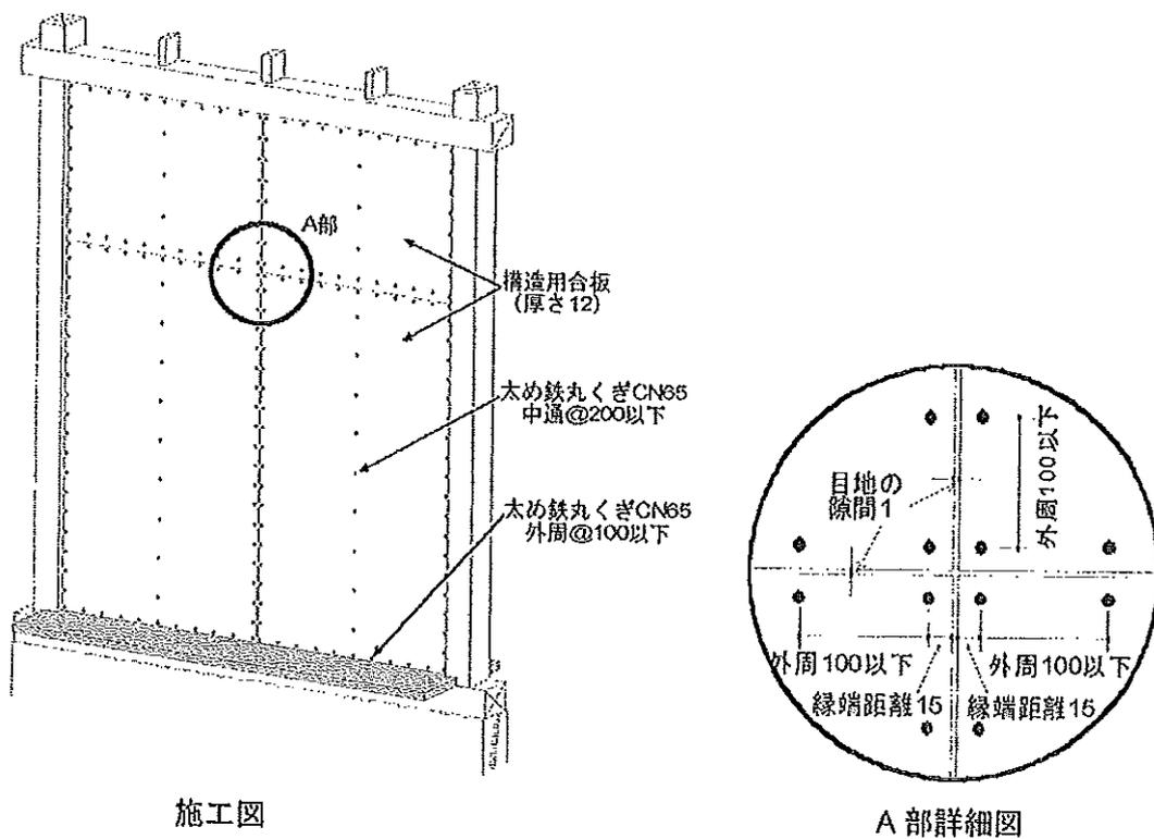
図3 施工図詳細 (mm)
