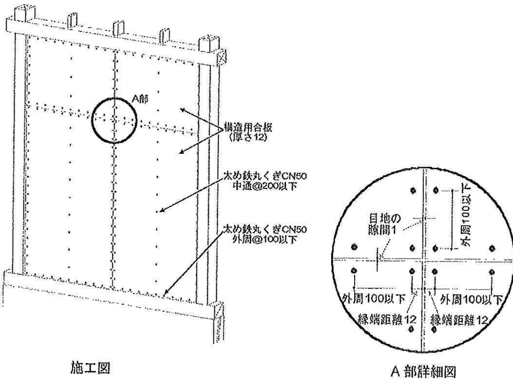
図3 施工図詳細 (mm)
