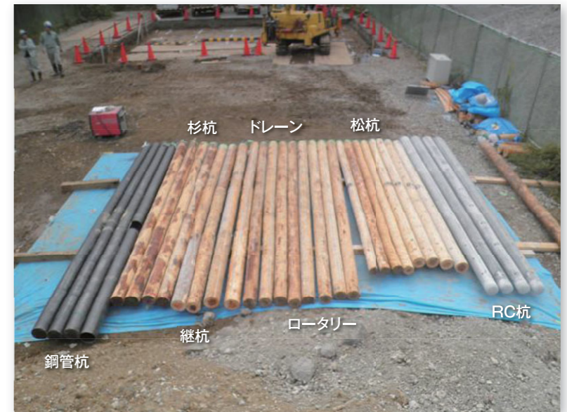
試験に用いた杭
