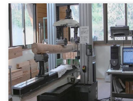
円柱材の強度試験の様子
