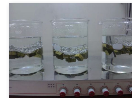
耐候操作試験(JIS K1571規定)
