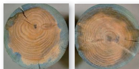
長さ別に浸潤度比較したスギ材 (左:4m 右:6m)
