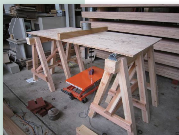
測定は0°方向(合板の長手方向)、90°方向(合板の短手方向)の両方向で実施
