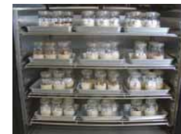
恒温恒湿器内の腐朽処理58日目 条件:温度26℃、湿度70%で60日間 塗布、無塗布試験体で比較試験
