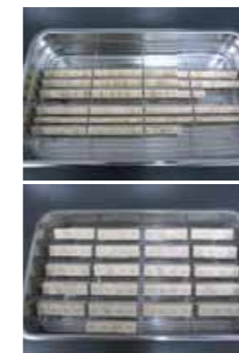
杉複合合板及び檜一杉合板より調整した12 号 試験体(上)、 檜一杉厚物合板より調整した24 号 試験体(下)
