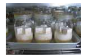
腐朽処理58日目の24 号 試験体
