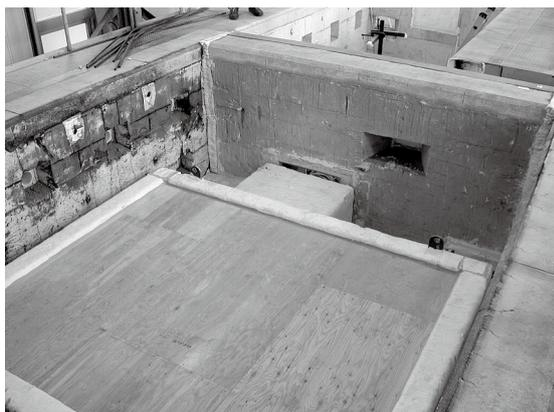
床上面加熱試験の試験体
