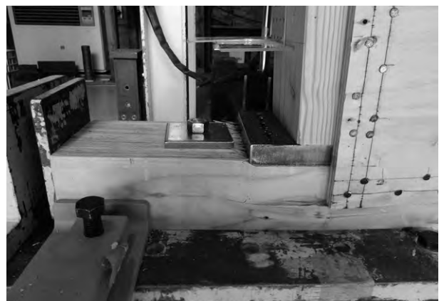
図 2-7 柱の横架材へのめり込み
