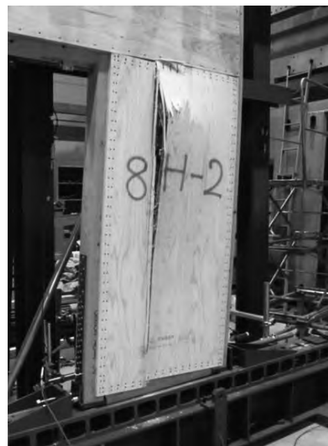
試験体8H-2 合板のせん断破壊
