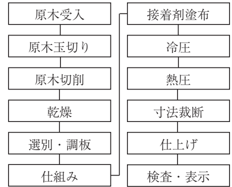
図 1-1 合板の製造工程
