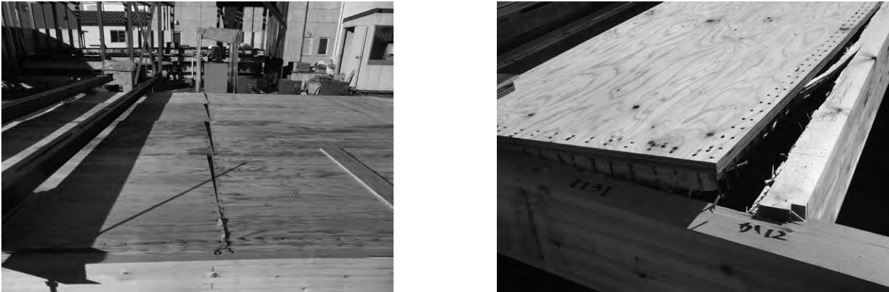
図 4-15 床構面試験体の破壊形態
