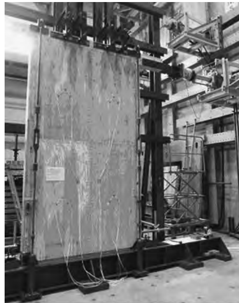
図3-4 タイロッド式試験方法
