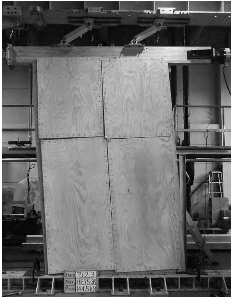
図3-10 通常の破壊形態
