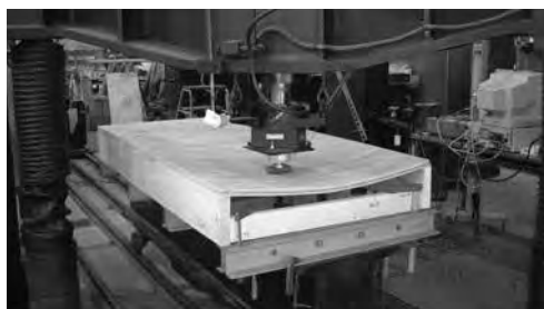
図5-23 集中荷重試験
