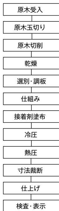
図1-1 合板の製造工程
