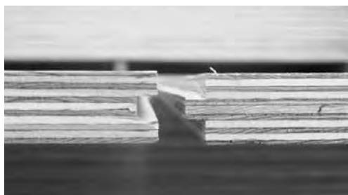
図5-22 試験したさねの形状
