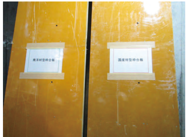
写真6. 1回使用済み合板 （ラワン型枠と国産材型枠に特に差はない）
