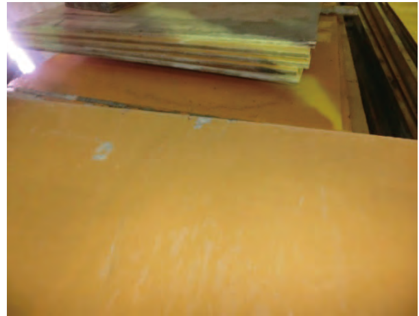
写真4. 1回目使用塗装面（シワがついている） (仕上がりでは特に問題なし)
