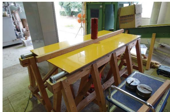
写真 1. 実大曲げ剛性試験の様子
