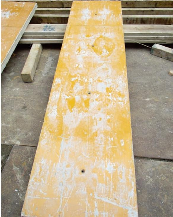
1 4回使用后（壁）（ラワン型枠）
