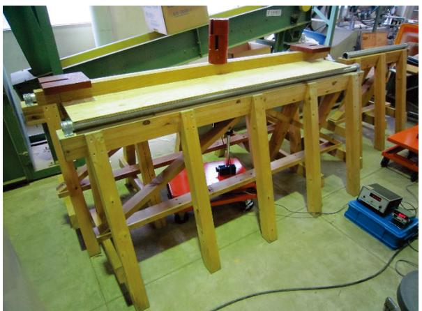
写真 1. 実大曲げ剛性試験の様子
