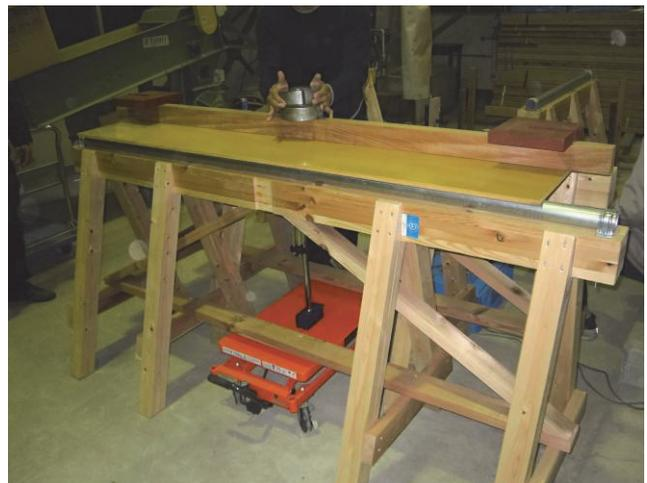
写真 1. 実大曲げ剛性試験装置
