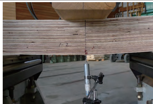
1-2 曲げ破壊 1.43N/mm 2
