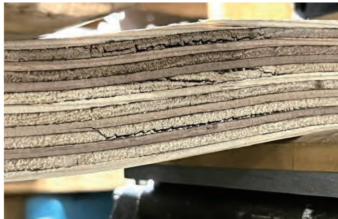
写真 7-3 主な破壊形態－せん断破壊
