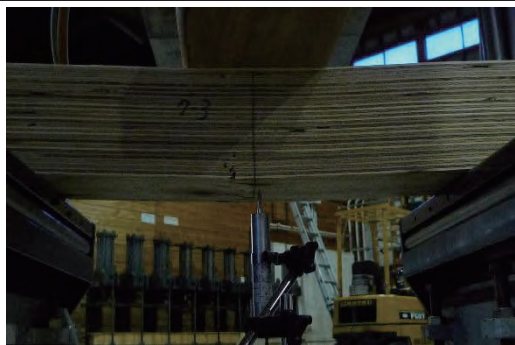
7-3 曲げ破壊 1.31N/mm 2
