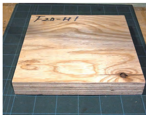
図 9-4 試験体の一例(厚さ 45mm)
