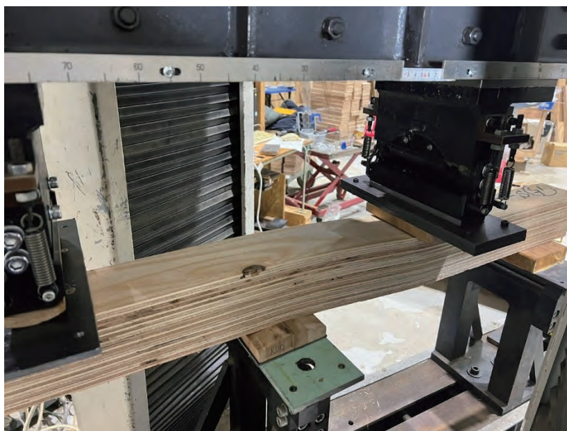
写真 7-5 厚さ 90mm 試験体 逆対称 4 点荷重方式せん断試験の様子
