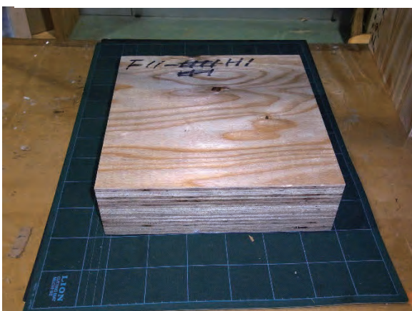
図 11.1.4-5 熱伝導率試験体 (90mm : 平行層のみ 60N/m 2 以上)
