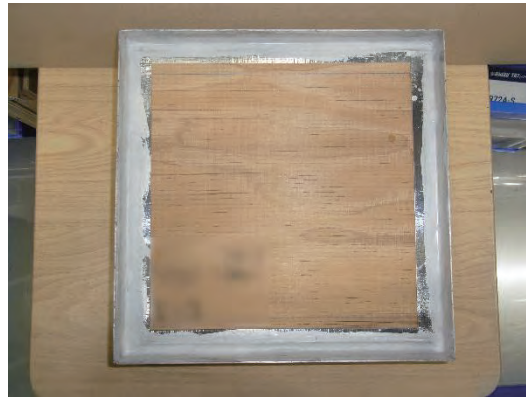
図 11.1.4-14 JIS 準拠透湿カップ ※アルミテープとパラフィンで密封
