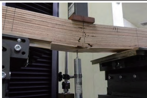
13-1 曲げ破壊 1.14N/mm 2
