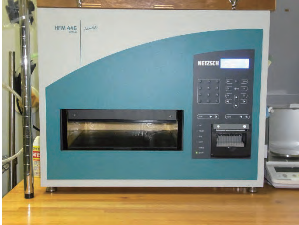
図 11.1.4-1 熱伝導率測定装置 (試験体設置口開口状態)
