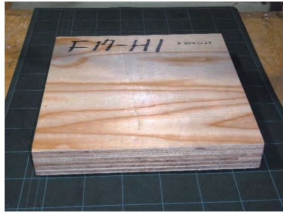
図 11.1.4-8 熱伝導率試験体 (45mm : 全層 60N/m 2 以上)
