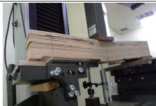
15-4 複合破壊 1.63N/mm 2
