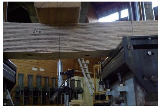
5-6 曲げ破壊 1.50N/mm 2
