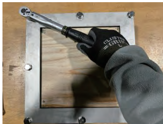
図 11.1.4-16 透湿カップの密封作業 ※ボルト締めにより密封するため、トルクレンチを用いた締付トルク管理が必要
