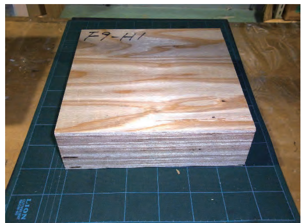
図 11.1.4-4 熱伝導率試験体 (90mm : 全層 60N/m 2 以上)
