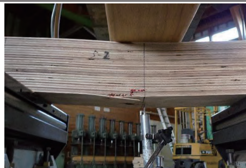
5-2 曲げ破壊 1.31N/mm 2
