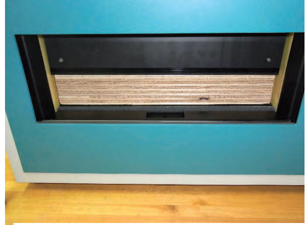
図 11.1.4-2 試験体の設置 (試験体上部の黒いブロックは熱盤)
