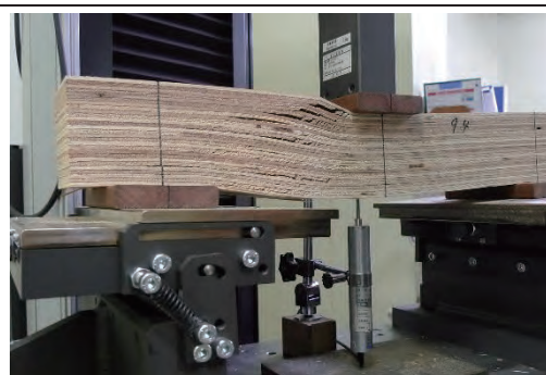
9-4 せん断破壊 1.66N/mm 2
