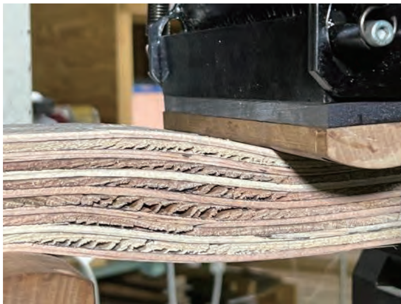
写真 7-1 せん断試験時に直交層単板の裏割れから発生したローリングシア
