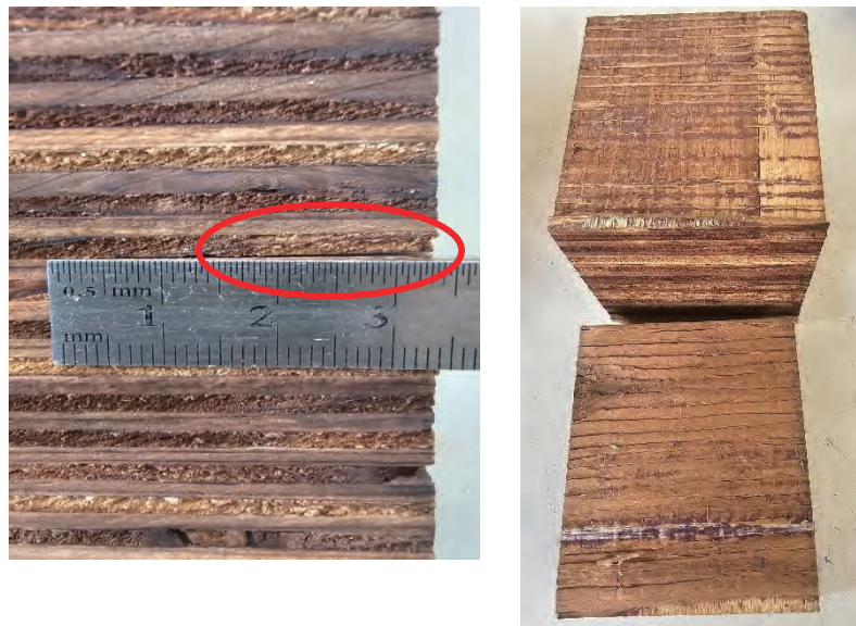
写真 6-2 同一接着層における剥離の様子 (左：試験片側面における剥離（赤枠内）、右：当該接着層を破断した様子)
