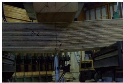
7-2 曲げ破壊 1.41N/mm 2
