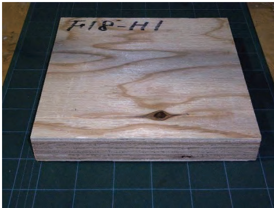
図 11.1.4-9 熱伝導率試験体 (45mm : 平行層のみ 60N/m 2 以上)
