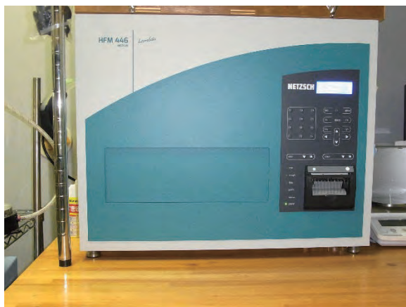
図 11.1.4-3 断熱シャッターの閉鎖 (測定状態)
