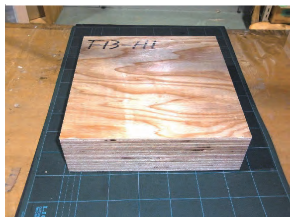
図 11.1.4-6 熱伝導率試験体 (90mm : 表層のみ 60N/m 2 以上)
