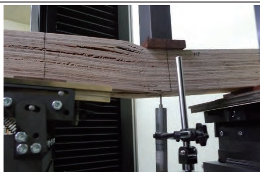
11-1 せん断破壊 1.34N/mm 2
