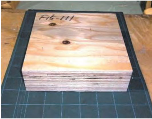
図 11.1.4-7 熱伝導率試験体 (90mm 表層のみ板面品質 C-D)
