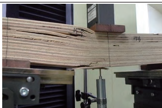
15-5 複合破壊 1.66N/mm 2
