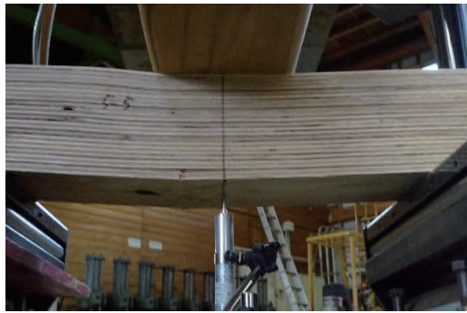
5-5 曲げ破壊 1.38N/mm 2
