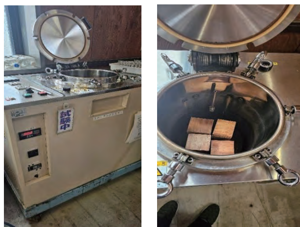
写真 6-1 減圧加圧剝離試験の様子
