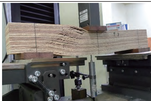
9-3 せん断破壊 1.65N/mm 2
