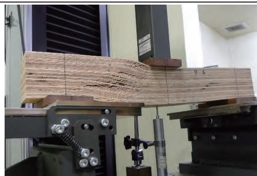
9-6 せん断破壊 1.63N/mm 2
