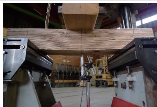
5-4 複合破壊 1.48N/mm 2
