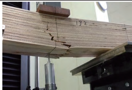
13-2 曲げ破壊 1.25N/mm 2
