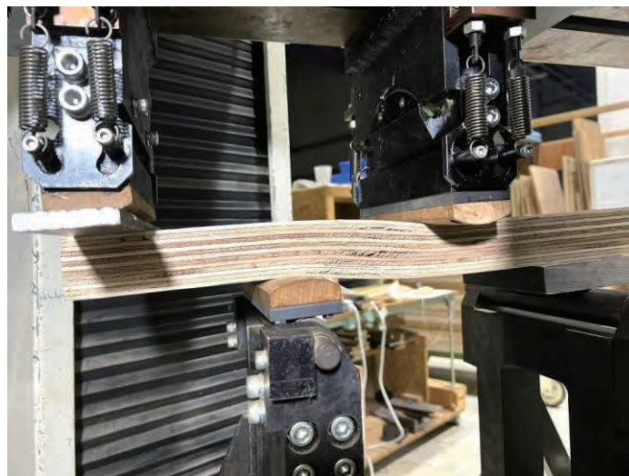
写真 7-2 厚さ 45mm 試験体 逆対称 4 点荷重方式せん断試験の様子
