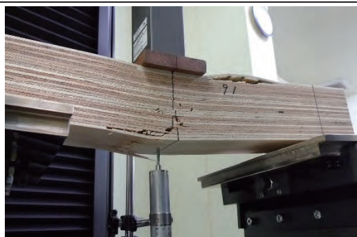
9-1 曲げ破壊 1.59N/mm 2
