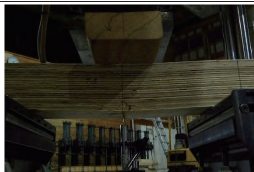
7-6 曲げ破壊 1.29N/mm 2
