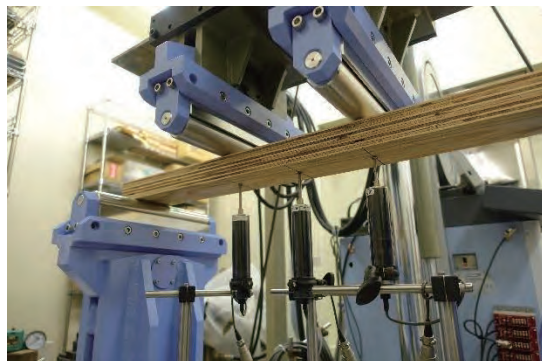
(a) 変位計設置
