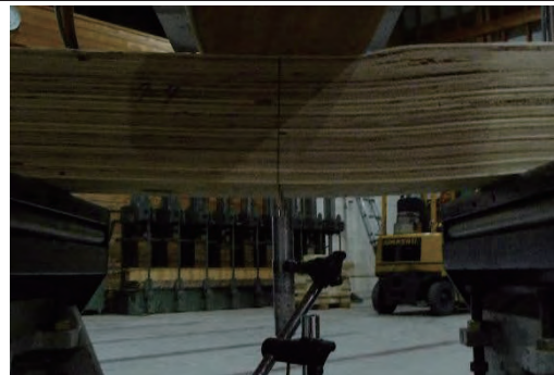
7-4 せん断破壊 1.38N/mm 2
