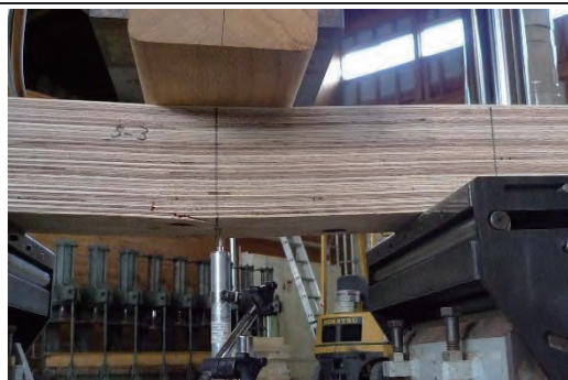
5-3 曲げ破壊 1.44N/mm 2
