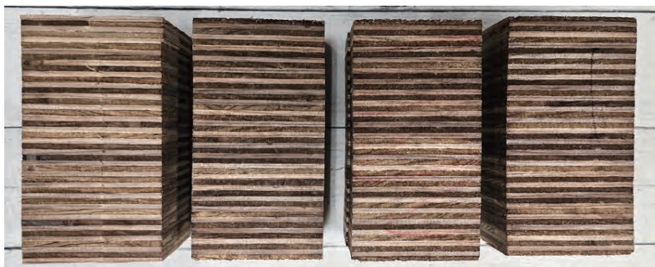
写真 6-3 製造条件変更後の超厚合板試験体の減圧加圧剥離試験の様子
