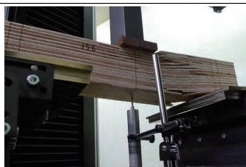
15-6 複合破壊 1.64N/mm 2
