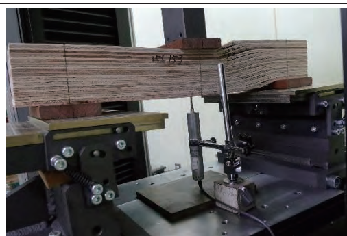
15-2 せん断破壊 1.69N/mm 2
