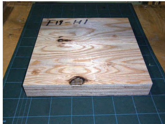
図 11.1.4-10 熱伝導率試験体 (45mm : 表層のみ 60N/m 2 以上)
