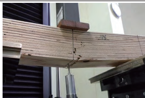
13-6 曲げ破壊 1.22N/mm 2
