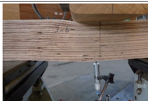
3-6 せん断破壊 1.48N/mm 2
