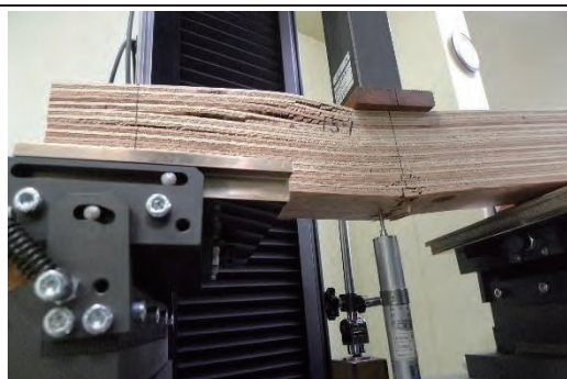
15-1 曲げ破壊 1.59N/mm 2
