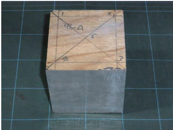
図 11.1.4-19 厚さ変化試験体 (スギ：公称厚さ 96mm)
