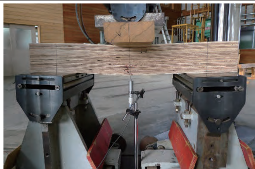
1-1 曲げ破壊 1.56N/mm 2
