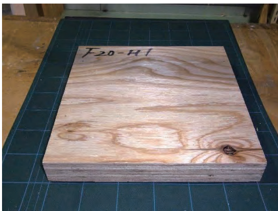
図 11.1.4-11 熱伝導率試験体 (45mm 表層のみ板面品質 C-D)
