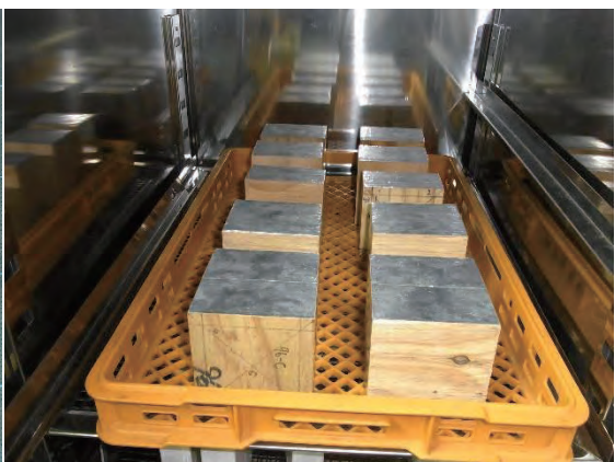
図 11.1.4-24 恒温恒湿器内の設置状況
