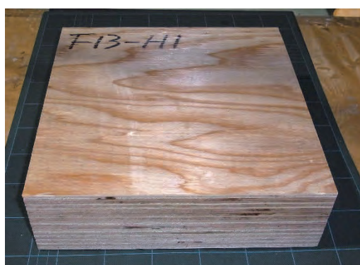
図 9-3 試験体の一例(厚さ 90mm)
