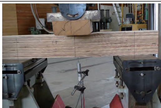
1-5 せん断破壊 1.44N/mm 2
