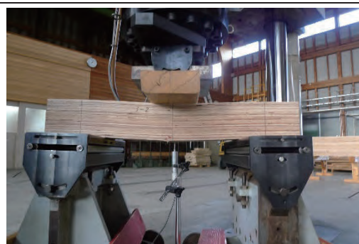
3-2 曲げ破壊 1.49N/mm 2
