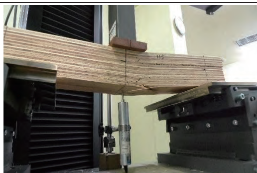
11-5 複合破壊 1.48N/mm 2
