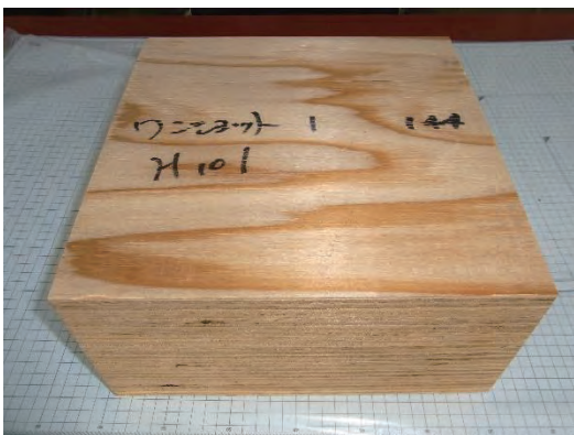
図 11.1.4-17 透湿試験体 ※ワンショット試験体の同等品
