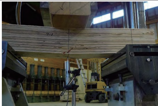
7-1 曲げ破壊 1.41N/mm 2
