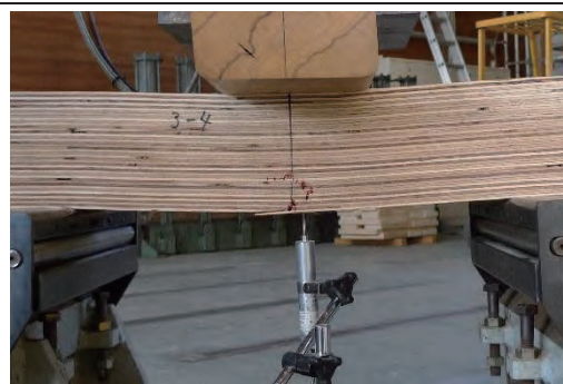
3-4 曲げ破壊 1.46N/mm 2
