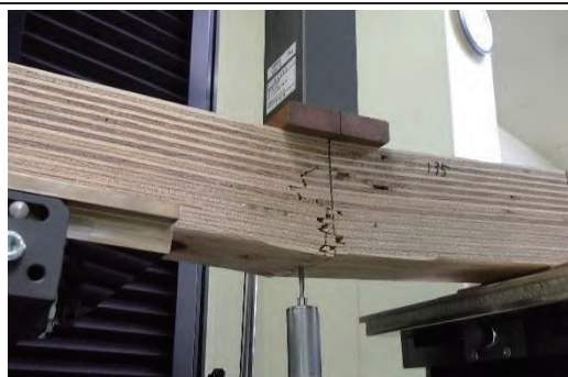
13-5 曲げ破壊 1.29N/mm 2
