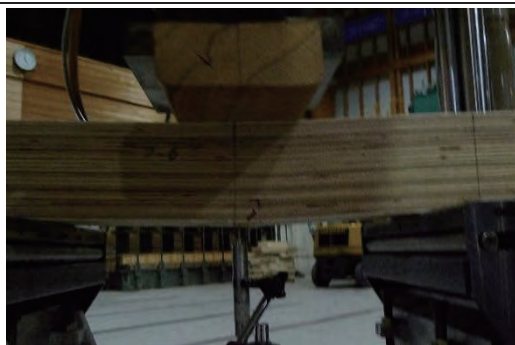
7-5 曲げ破壊 1.31N/mm 2
