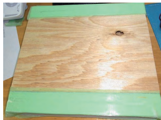
図 11.1.4-12 熱伝導率試験体 ※幅 200mm の場合、スチレンボードを付加
