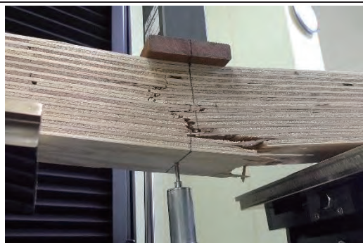
13-3 曲げ破壊 1.54N/mm 2
