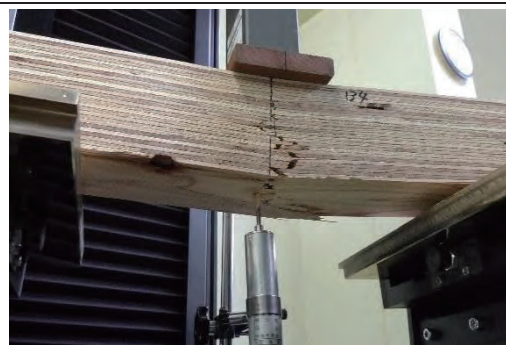
13-4 曲げ破壊 1.24N/mm 2
