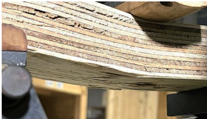
写真 7-4 主な破壊形態－曲げ破壊
