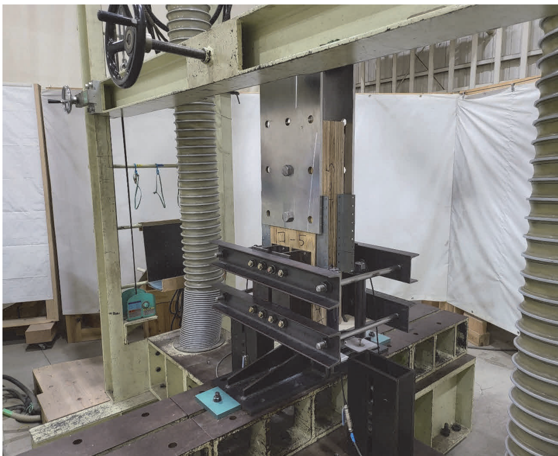
写真 8-3 接合部試験実施状況
