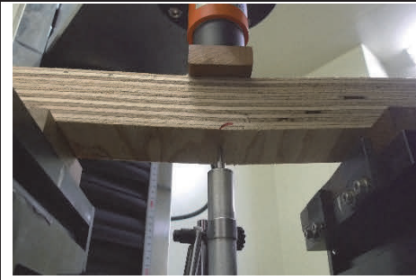
スギワンショット逆寸平使い 1011 曲げ破壊 1.28N/mm 2
