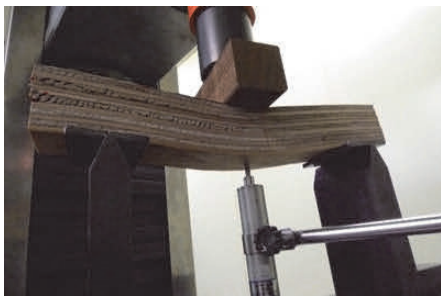
スギ 5h 平使い 6089 107 せん断破壊 (ローリングシア) 2.08\text{N/mm}^2
