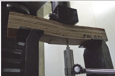
カラマツ 4h 平使い 120129 106 せん断破壊 (ローリングシア) 2.16\text{N/mm}^2
