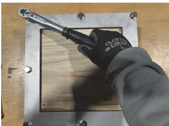
図 12.1.7-13 トルクレンチによる圧縮管理 ※測定中、定期的にトルク管理を行う
