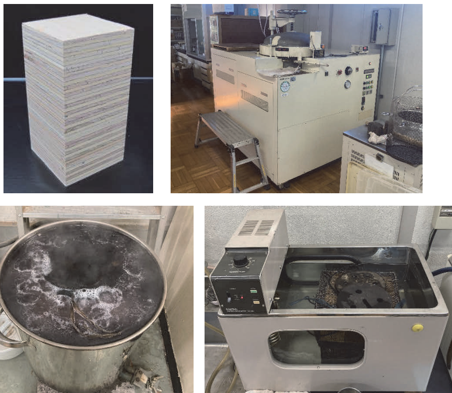
図 7-1 接着剥離試験片 (左上)、減圧加圧処理装置 (右上)、煮沸処理の様子 (左下)、煮沸処理後の浸せき処理の様子 (右下)
