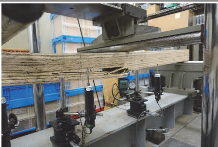
写真 12.1.1-5 最大荷重後 (概況)
