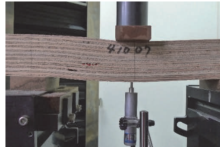
カラマツ合板 40 逆寸平使い 1007 せん断破壊 (ローリングシア) 2.24\text{N/mm}^2
