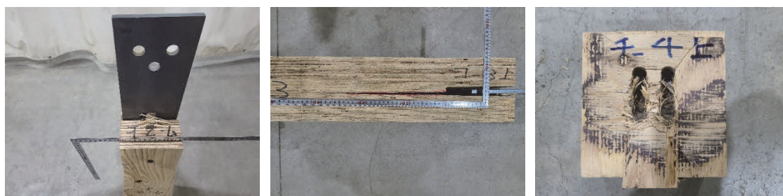
写真 8-4 破壊性状（左上：せん断破壊、右上：面外割裂破壊、左下：集合型せん断破壊）
