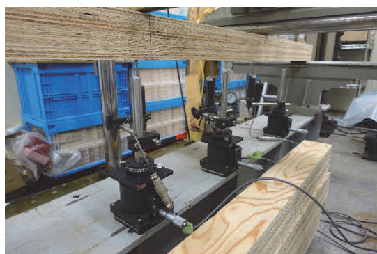
(a)変位計設置
