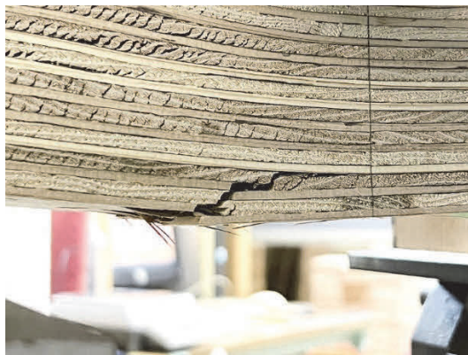
写真 6-5 ③ 引張側の曲げ破壊(以下, 「BF」と呼ぶ) ※ 写真はスギ合板型通常仕様型
