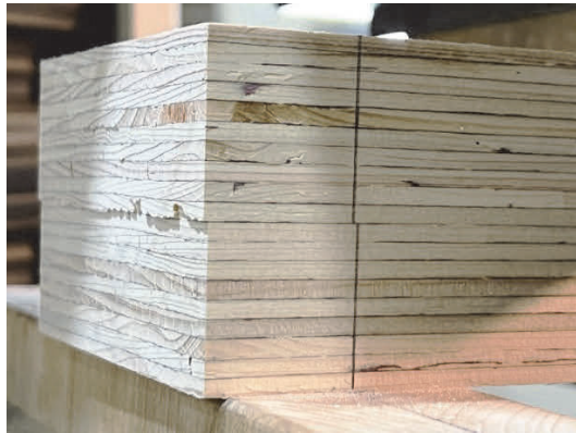
写真 6-3 ① 接着層のせん断破壊(以下, 「SH」と呼ぶ) ※ 写真はヒノキ LVL 型
