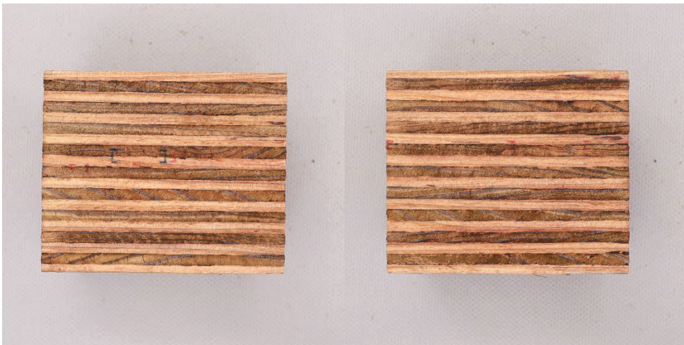
写真 12-1-4-11 試験後の様子 (カラムツ・合板型通常仕様) (減圧加圧)
