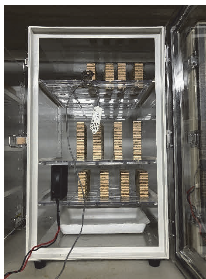
図 12. 1. 7-18 調湿用デシケータ ※空気攪拌用ファン，温湿度センサを設置
