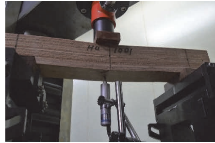
カラマツ合板 40 正寸平使い 1001 曲げ破壊 1.50\text{N/mm}^2
