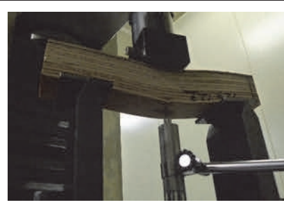
カラマツ 4h 平使い 120129 129 曲げ破壊 (めり込み) 2.96\text{N/mm}^2
