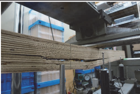
写真 12.1.1-7 最大荷重後 (概況)
