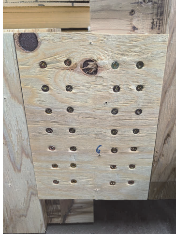
図 12.1.6-5 面内せん断試験破壊性状（合板のせん断破壊・ロッキング変形）
