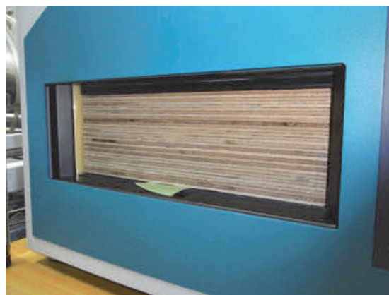
図 12.1.7-6 試験体の設置 ※試験体下のテープは試験体の取出用
