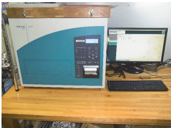
図 12.1.7-3 熱伝導率測定装置の全体 ※PCによって制御と記録, 計算を行う
