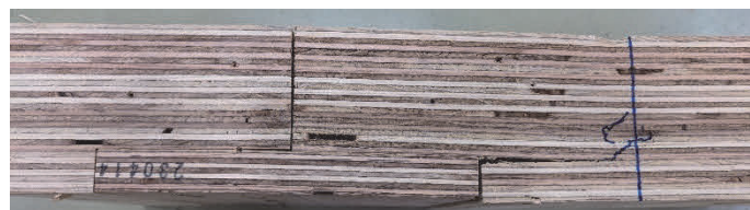
図 12.1.6-4 面外せん断試験破壊性状（上段：せん断破壊、下段：曲げ破壊）
