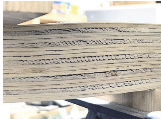
写真 6-4 ② 単板裏割れのローリングシアによる破壊(以下, 「RS」と呼ぶ) ※ 写真はヒノキ B 種 LVL 型
