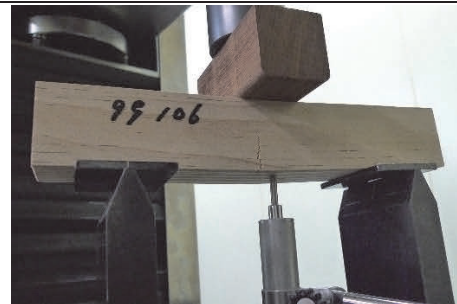
ヒノキ 4h 縦使い 9099 106 曲げ破壊 5.42\text{N/mm}^2
