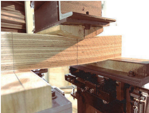
写真 6-1 LVL 規格に準拠した水平せん断試験 (4hR9) の概要 (スパン 4h, 支点幅 50mm 平板, 加力点 R90mm 曲板)
