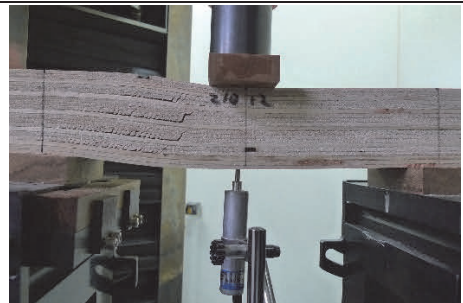
ヒノキ BLVL 逆寸平使い 1012 せん断破壊 (ローリングシア) 1.54N/mm 2
