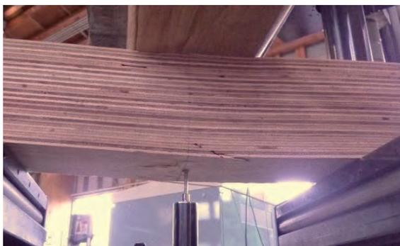
写真 6-2 正寸平使い曲げ破壊
