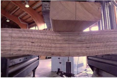
写真-23 ランダム2次接着⊥平使い704 (めり込み)
