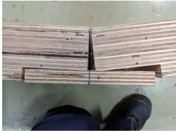
写真 13. 1. 6-4 破壊性状 (仕様 D)
