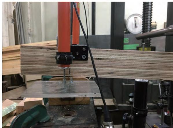
図 13. 1. 1-4 支点の変位計の設置
