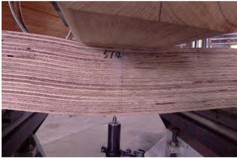
写真-15 ランダムワシヨット平使い 514 (めり込み破壊)
