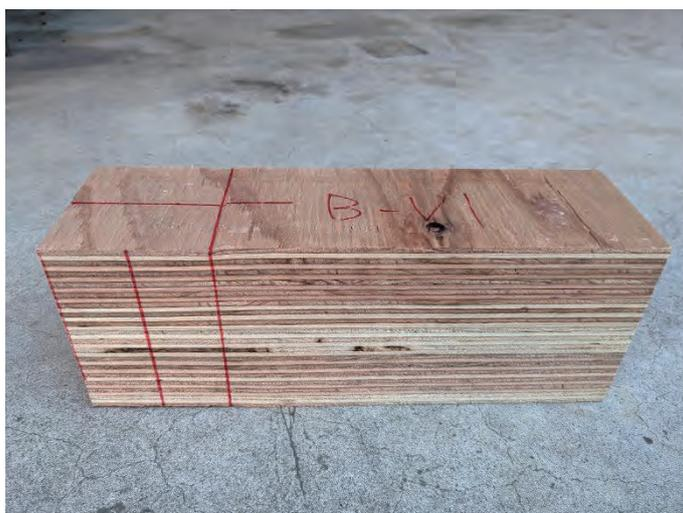
写真 13.1.6-9 めり込み試験 V 仕様（支持条件 C）破壊性状
