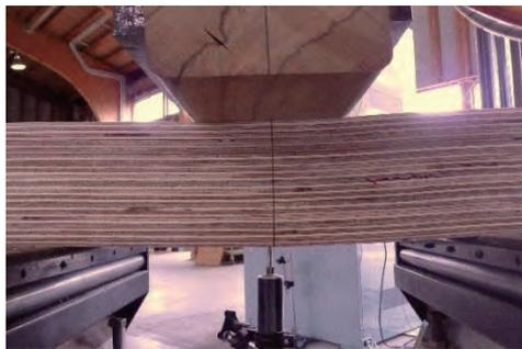
写真-8 E60 ⊥ 2次接着平使い 801 (せん断破壊)
