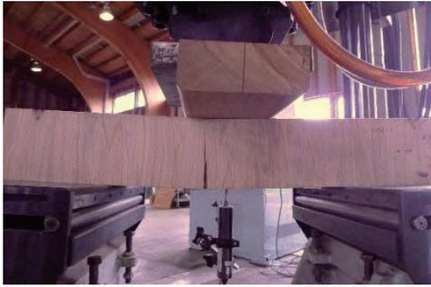
写真-11 E60 2次接着⊥縦使い 802 (曲げ破壊)
