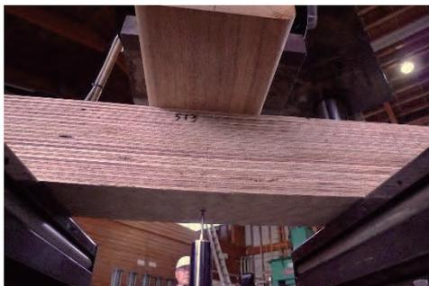
写真-14 ランダムリソット平使い 513 (曲げ破壊)
