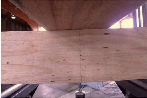
写真 6-4 正寸縦使いせん断破壊
