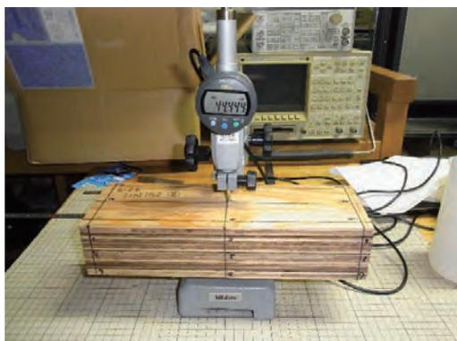
図 13.1.7-10 吸湿試験の厚さ測定 (60mm)
