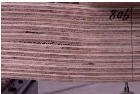
写真-10 E60 2次接着平使い ⊥ 806 (めり込み破壊)
