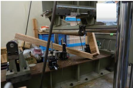
写真 13.1.2-3 最大荷重後 (概況)
