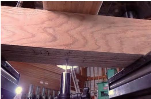
写真 6-5 正寸縦使い曲げ破壊
