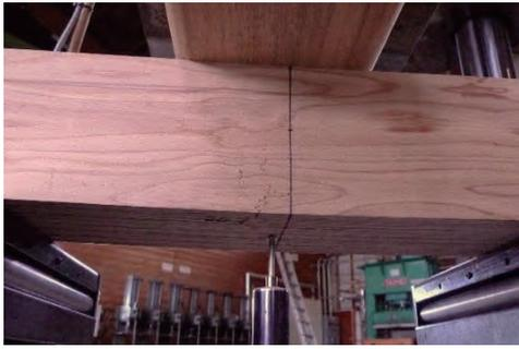
写真-7 E60 2次接着縦使い 203 (曲げ破壊)
