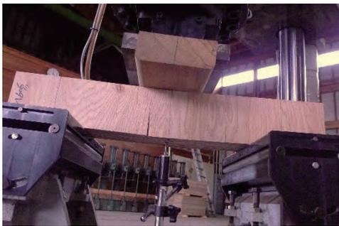
写真-24 ランダム2次接着⊥縦使い (曲げ破壊)
