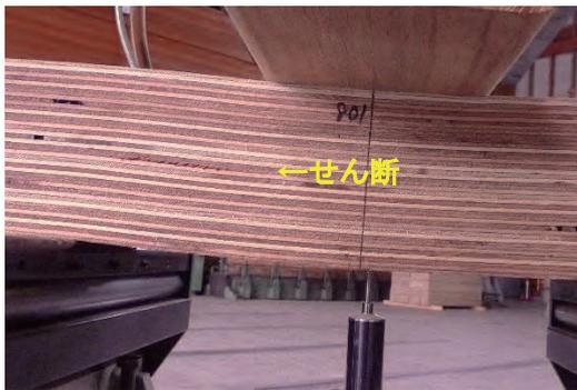
写真 6-6 逆寸平使いせん断破壊
