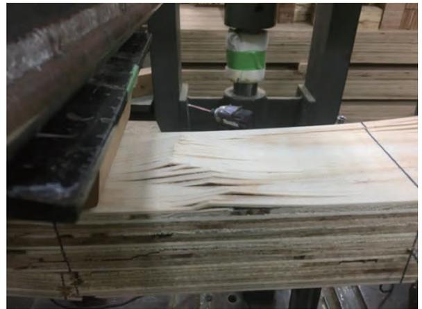
図 4-8 圧縮破壊の性状
