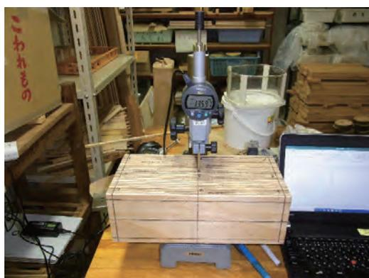
図 13.1.7-11 吸湿試験の厚さ測定 (144mm)
