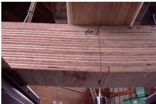
写真 6-7 逆寸平使い曲げ破壊
