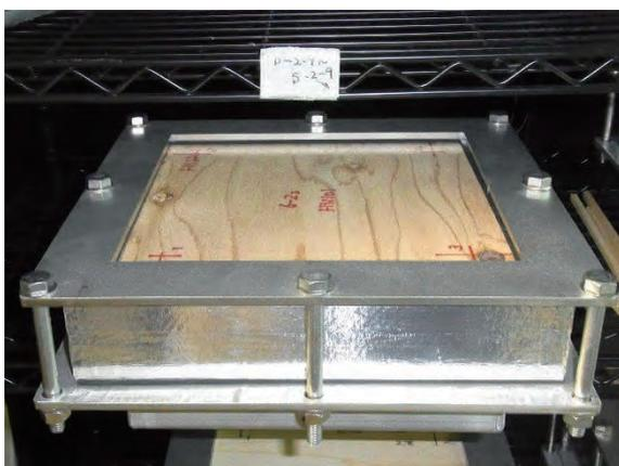
図 13.1.7-14 透湿カップ試験体(60mm)
