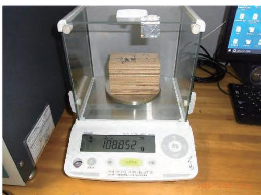
図 13.1.7-12 含水率-厚さ寸法変化試験における重量測定
