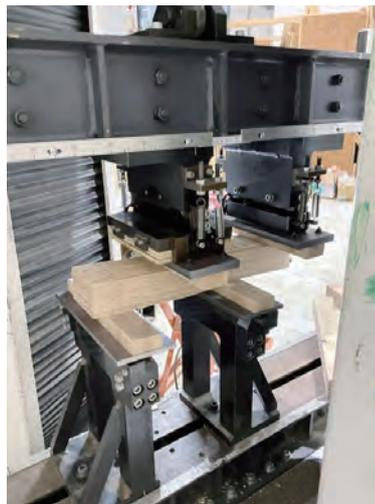
写真 7-1 逆対象4点荷重方式せん断試験の様子 (S=a=120mm)
