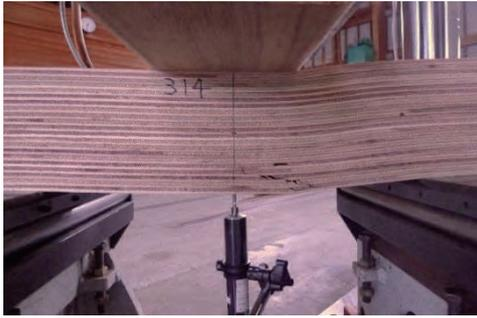
写真-3 E60 ワンショット平使い 314 (曲げ破壊)
