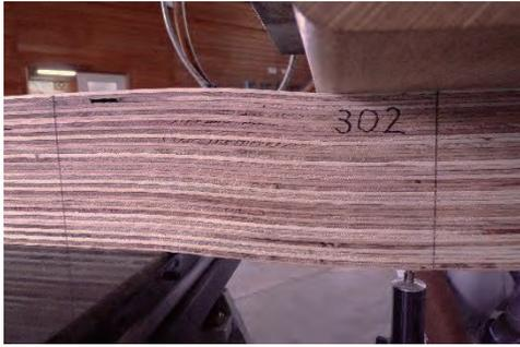
写真-19 ランダム2次接着平使い 302 (めり込み破壊)
