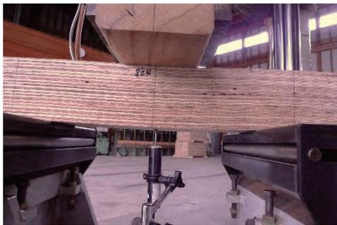
写真-21 ランダム2次接着⊥平使い 804 (せん断破壊)
