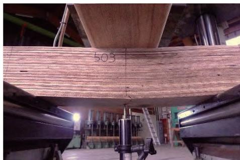
写真-18 ランダム2次接着平使い 503 (曲げ破壊)
