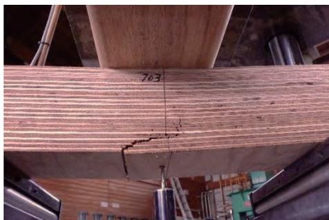
写真-9 E60 2次接着⊥平使い 703 (曲げ破壊)
