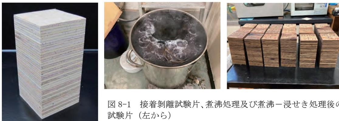
図 8-1 接着剥離試験片、煮沸処理及び煮沸一浸せき処理後の試験片（左から）
