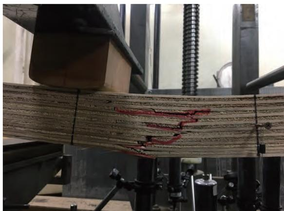
図 4-4 曲げ破壊の性状
