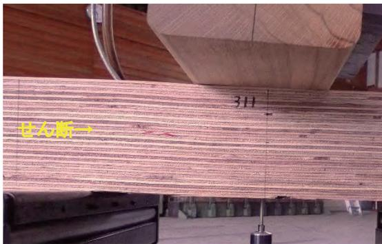
写真 6-1 正寸平使いせん断破壊
