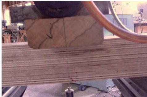
写真-13 ランダムリソット平使い 412 (せん断+曲げ破壊)
