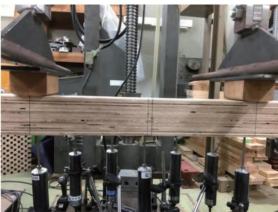
図 13. 1. 1-5 中央、加力点の変位計の設置
