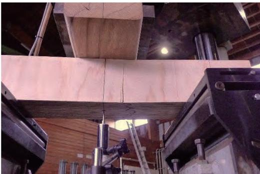
写真 6-9 逆寸縦使い曲げ破壊
