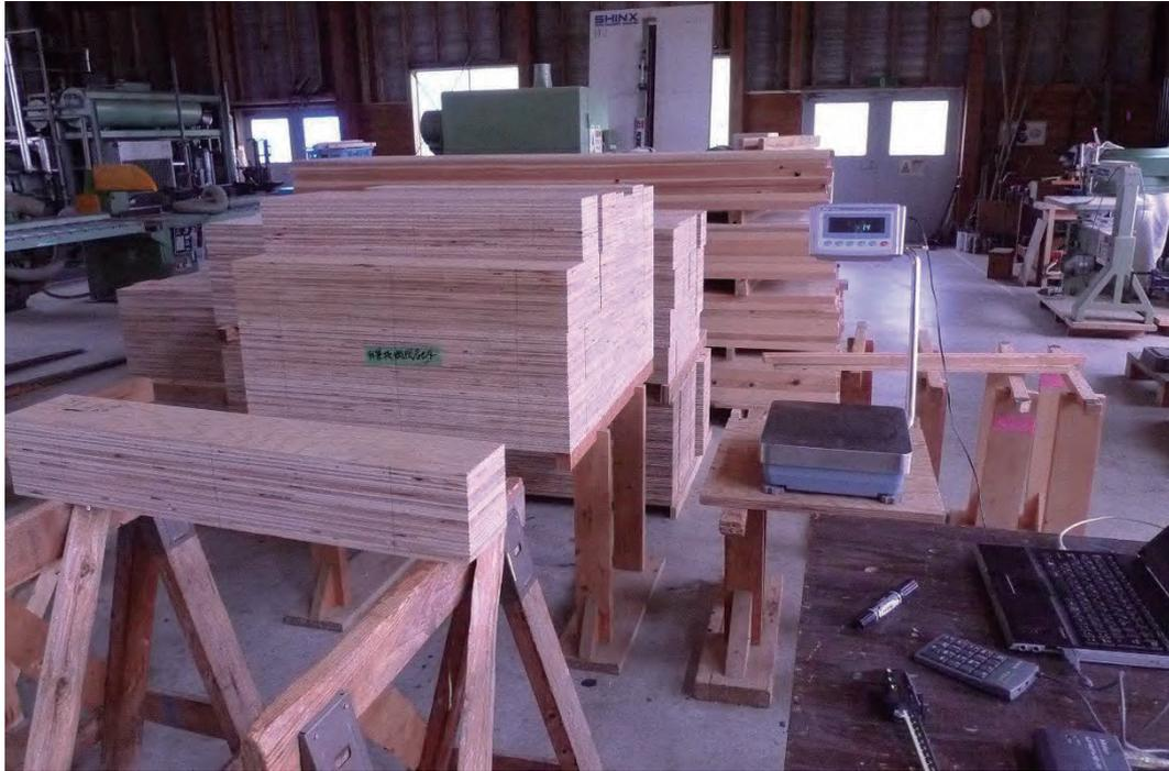
写真-1 スギ試料材の重量，寸法測定
