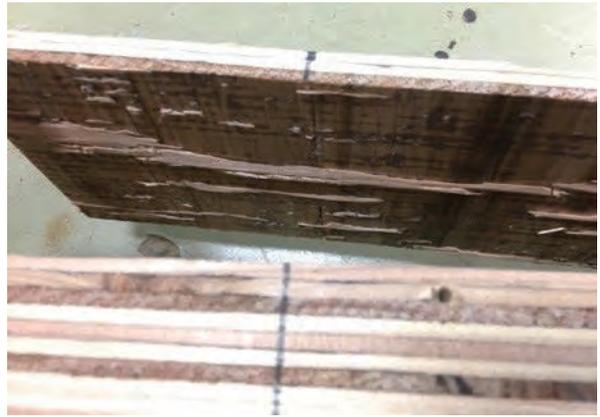
図 4-7 接着層が破壊したせん断破壊の性状
