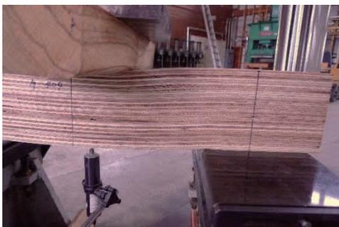
写真-6 E60 2次接着平使い 202 (めり込み破壊)
