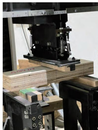
写真 7-3 水平せん断試験の様子
