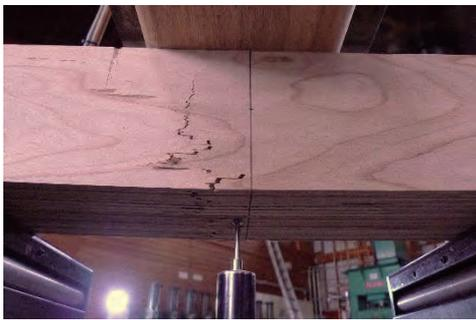
写真-20 ランダム2次接着縦使い 101 (曲げ破壊)
