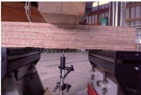
写真-12 ランダムリソット平使い 311 (せん断破壊)
