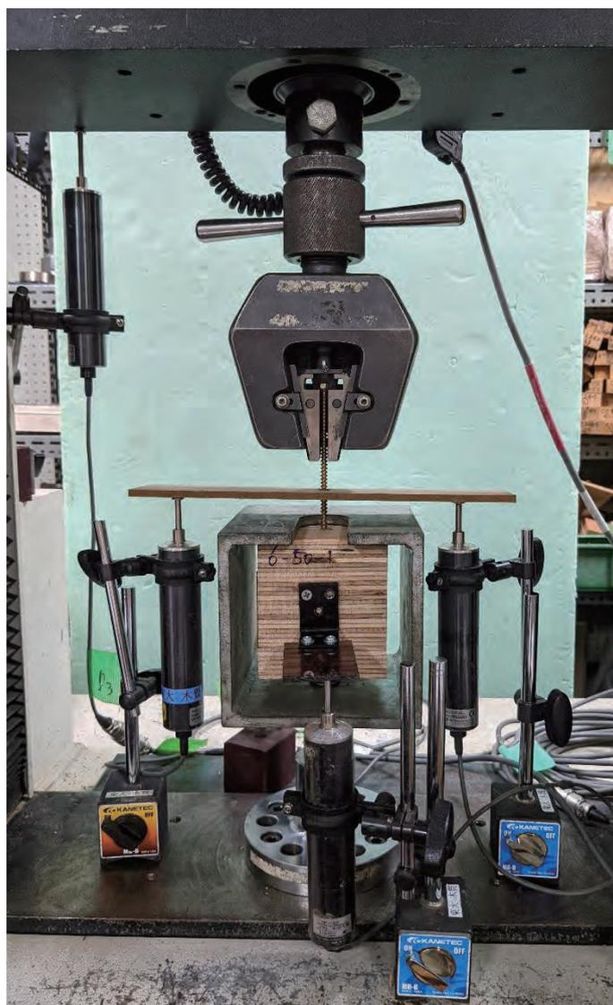
写真 13. 1. 6-10 ビス引き抜き試験の様子
