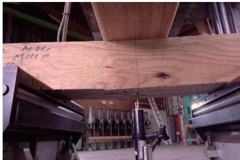
写真-5 E60 ワンショット 111 縦使い (曲げ破壊)
