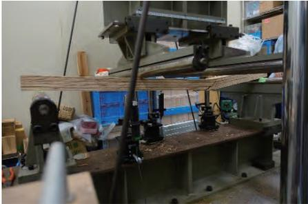
写真 13.1.2-5 最大荷重後 (概況)
