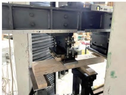
写真 7-2 逆対象4点荷重方式せん断試験の様子 (S=a=180mm)
