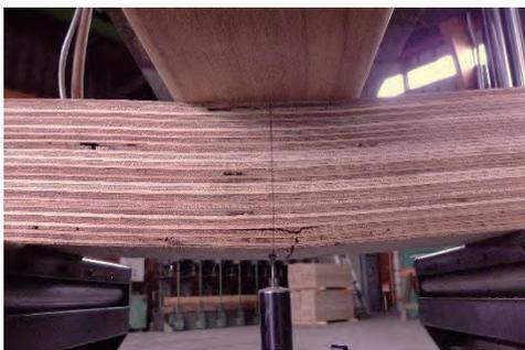
写真-22 ランダム2次接着⊥平使い 605 (曲げ破壊)
