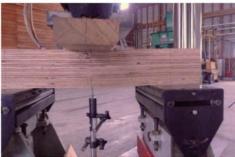
写真-4 E60 ワンショット平使い 112 (めり込み破壊)
