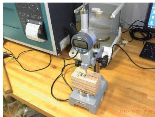
図 13.1.7-13 含水率-厚さ寸法変化試験における厚さ測定
