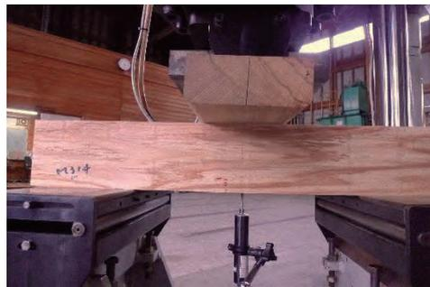
写真-17 ランダムワシヨット縦使い 314 (曲げ破壊)
