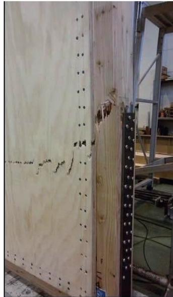
図 13 柱の引張破壊
