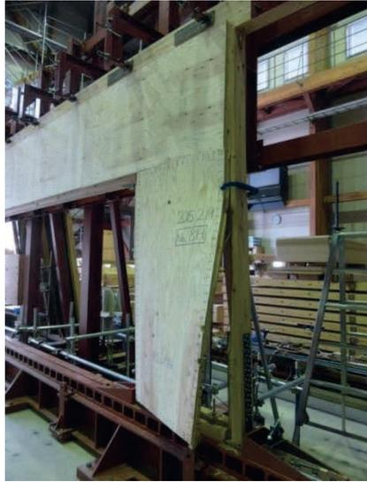
試験体 8H 柱の破壊
