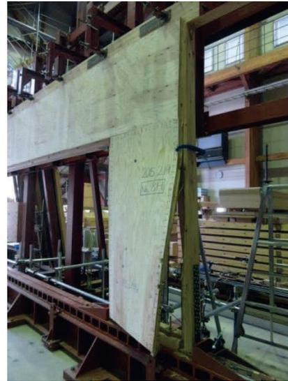
8H 釘接合部の破壊後の面外への変形
