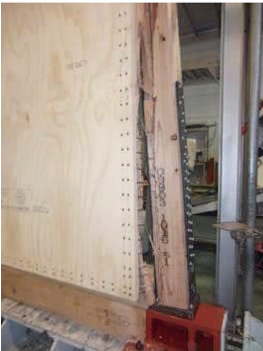
図16. 柱の引き裂き・引張破壊
