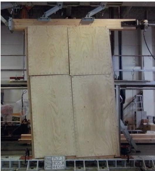
図 12 通常の破壊形態
