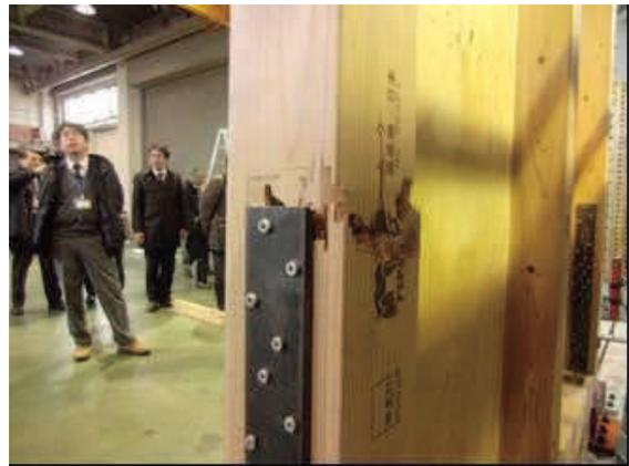
図 20. 高強度耐力壁の破壊形態
