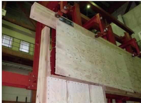
4M 釘接合部の破壊後に柱が横引張で割裂
