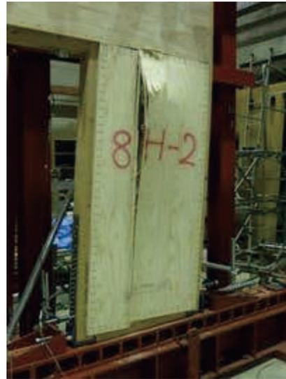
試験体 8H 合板のせん断破壊
