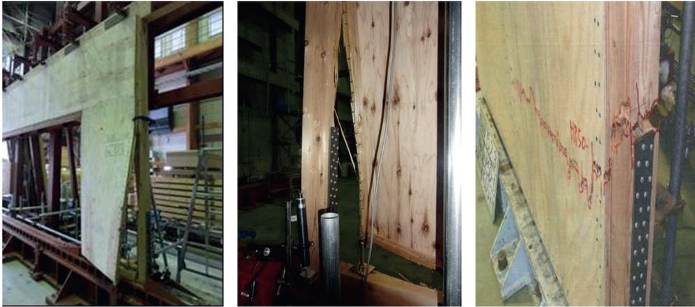
図1. 前年度に見られた柱の破壊
