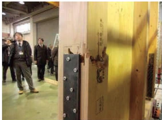
図15. 柱の引張破壊
