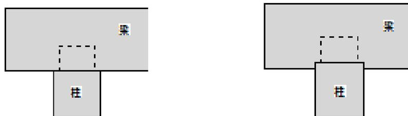
図4. 柱-桁仕口の改良 左：通常のホゾ、右：柱大入れ+ホゾ
