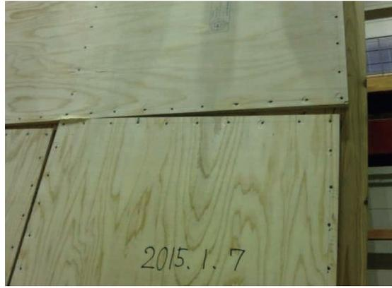
2B 合板のずれと釘接合部の変形
