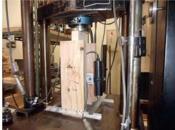
図 22 釘接合部のせん断試験
