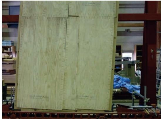
試験終了時（合板のせん断破壊）
