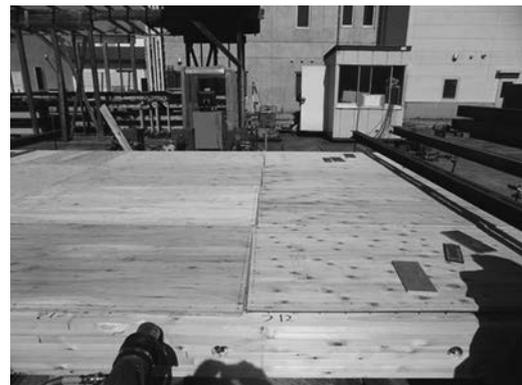
図 3-13 開口を有する床構面の破壊の状況
