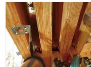
短尺材の縦方向割裂（スクリーを起点とした引き裂き）が先行。（CB-WRT/EJP-1）
