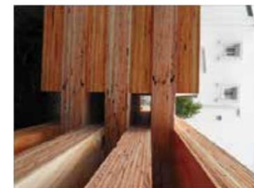
その後短尺材の曲げ破壊が発生した。（CB-WRT/EJP-1）
