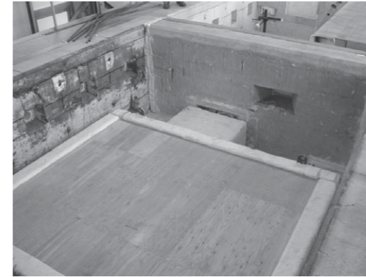
準耐火性能評価試験の試験体
